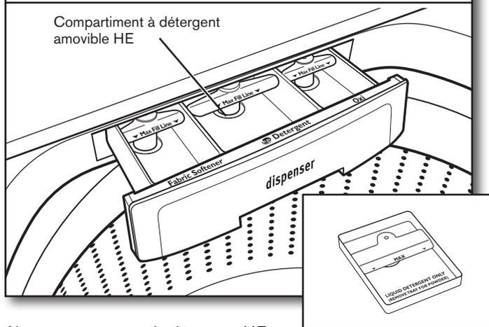
Ajouter une mesure de détergent HE dans le compartiment à détergent. La capacité de ce compartiment est de 3 oz (89 ml). Ne pas faire remplir excessivement le compartiment – le fait d'ajouter trop de détergent peut entraîner sa distribution prématurée dans la laveuse.
