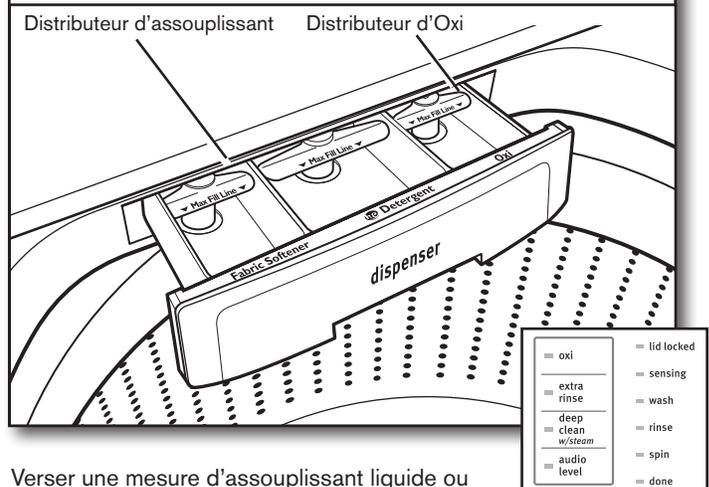
Verser une mesure d'assouplissant liquide ou d'activateurs de type Oxi dans le distributeur – toujours suivre les instructions du fabricant concernant la dose d'assouplissant ou d'Oxi à utiliser en fonction de la taille de la charge. Fermer le tiroir distributeur, puis sélectionner l'option Oxi. Le produit Oxi est ajouté lors du lavage principal et l'assouplissant est ajouté lors du rinçage.
