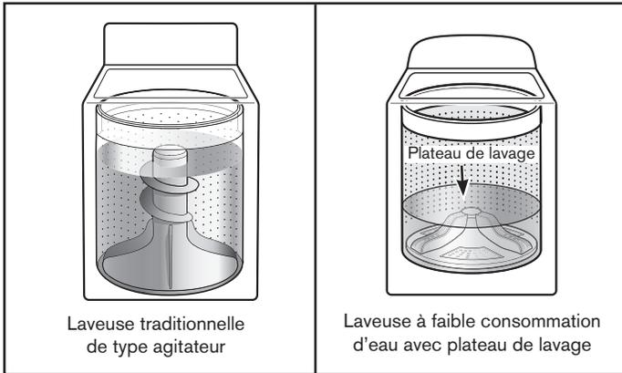
La nouveauté la plus incroyable de cette nouvelle laveuse est son système de lavage à faible consommation d'eau avec plateau de lavage. La laveuse ajuste automatiquement le niveau d'eau en fonction de la taille de la charge – nul besoin de sélecteur de niveau d'eau.
